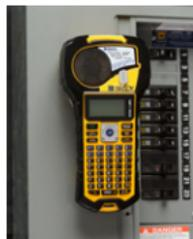
**Magnet und multifunktionales Zubehör:** Mit dem starken Magnet kann der Drucker zur freihändigen Bedienung an einer Metalloberfläche angebracht werden. Das multifunktionale Zubehör beinhaltet einen Magnet, eine Lampe und einen klappbaren Druckerständer.
